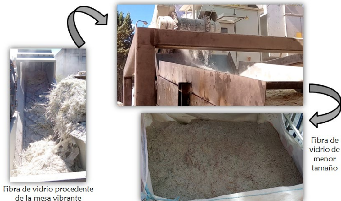
Figura 8. Trituración secundaria en el molino de martillos.
