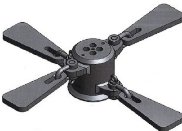
Figura 10. Configuración de los martillos en el diseño del molino.
