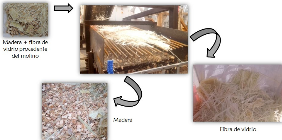
Figura 7. Separación de componentes a través de la mesa vibrante.
