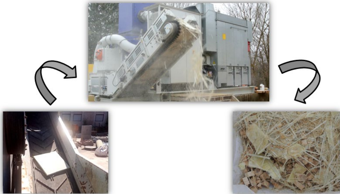
Figura 6. Trituración primaria llevada a cabo en el molino de martillos.
